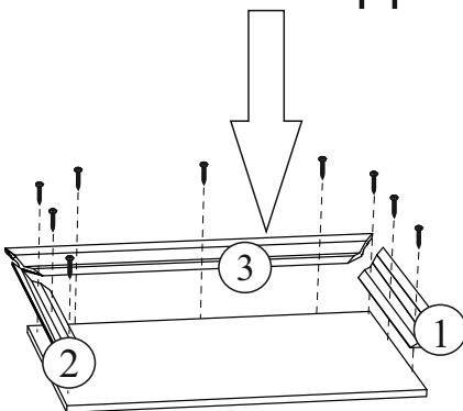
Карниз рекомендуется крепить в последнюю очередь, с помощью шурупов 4x25. Строго соблюдая угол 45 градусов между элементами карниза
